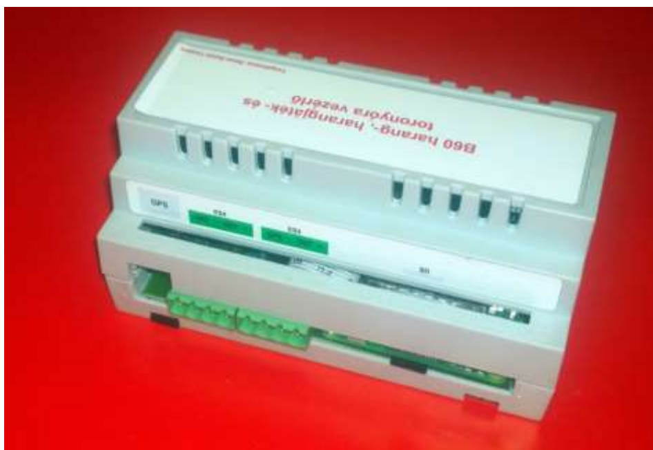
69. kép Az RB 60 elektronika felső oldalán lehet a GPS antennát, ES3, ES4 csatlakozókat és a SD kártyát bedugni.
