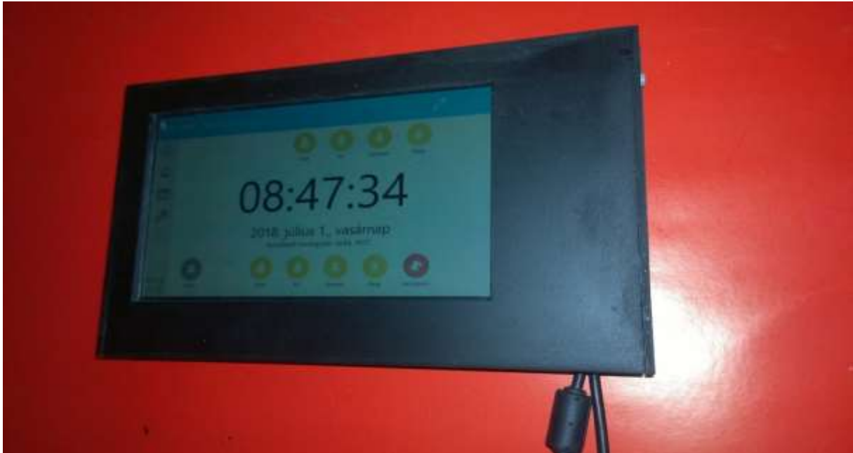
71. kép A dobozolt kijelző mérete 230x130x20mm. A bal oldalon látható gombbal a kijelzőt élettartamának megnövelése érdekében ki is lehet kapcsolni.
