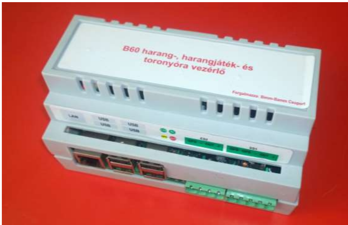
68. kép Az RB 60 elektronika doboza. Doboz alsó oldalán az ethernet kábelt, USB csatlakozókat és ES1, ES2 csatlakozókat bekötni. A készülék bal oldalán található a HDMI csatlakozó, hangkimenet, GPS2 csatlakozó, valamint a soros kimeneti vezérlőcsatlakozó található.
