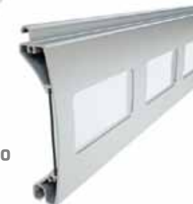
PER 77 Profil magassága: 77 mm Vastagsága: 18,5 mm
